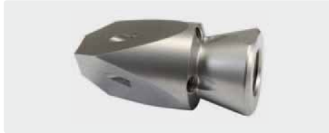
350 bar. 1/4" IG. Für Rohre > 30 mm. Seitliche Frontstrahlen 0,5 mm gebohrt.
