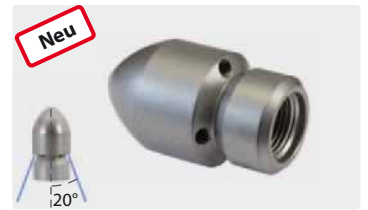
3/8" IG. Außen \varnothing 30 mm. 6 Bohrungen hinten
