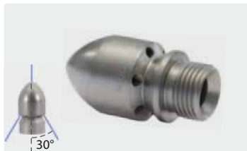
1/2" AG. AGR Dichtkonus. Außen \varnothing 30 mm. 6 Bohrungen hinten, 1 Bohrung vorn
